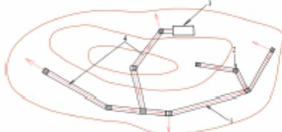
Рис. 1. Схема «Сетевой» дренажной системы.
