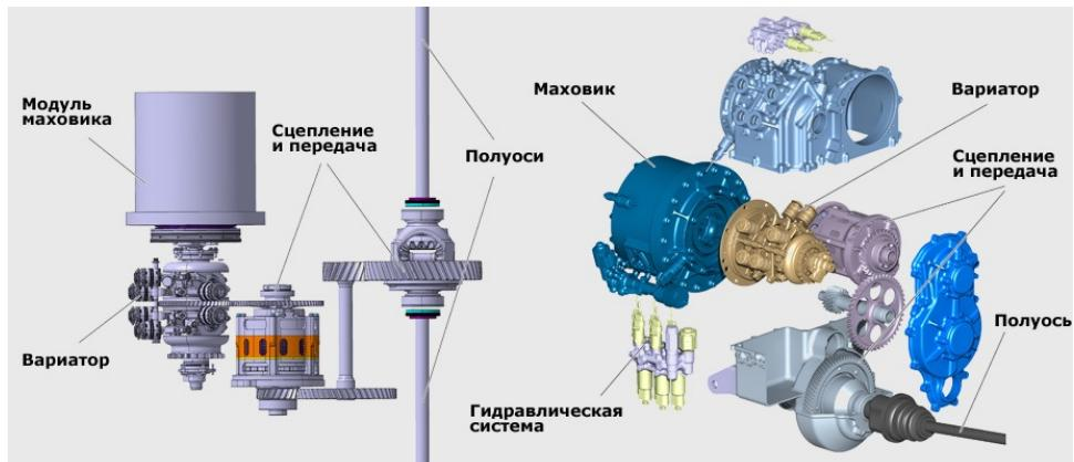
Одна из схем механической системы рекуперации энергии автомобиля
