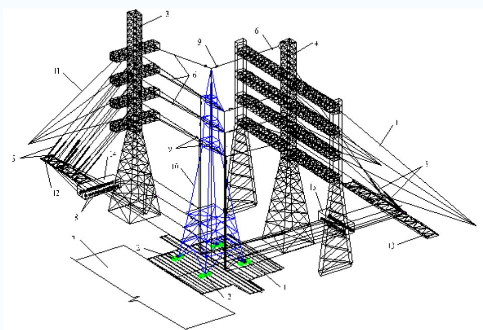
**Схема Полигона:** 1 – силовой пол; 2 – опорные силовые балки; 3, 4- силовые башня нормального и аварийного режима; 5 – полиспасты; 6 – натяжные тросы; 7 – сборочная площадка; 8 – ручные лебедки; 9 – электрические динамометры; 10 – испытываемая опора; 11 – оттяжки силовых башен; 12 ,13 – силовые фермы нормального и аварийного режима; 14 – силовые площадка нормального и аварийного режима
