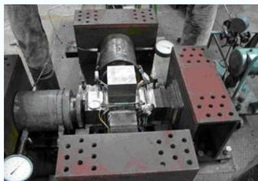
Установка для исследования сложного напряженного состояния в элементах железобетонных конструкций
