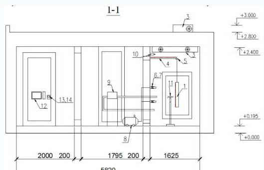
**Общий вид климатической камеры ДонНАСА:** 1 – холодильная камера, 2 – теплая камера, 3 – операторская комната. Схема экспериментальной установки: 1 – испытуемый профиль; 2 – холодная камера; 3 – компрессор BL-75; 4 – рычаг; 5 – электронный динамометр; 6 – форсунки; 7 – распылитель; 8 – компрессор; 9 – ветровая установка; 10 – датчик температуры и влажности; 11 – анемометр; 12 – персональный компьютер; 13 – регулятор TPM138; 14 – приборы СИ-8, ПКП-1
