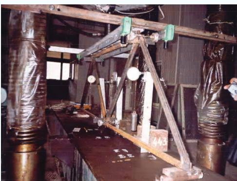
Испытание блока структурной конструкции в гидравлическом прессе (Р=1000 т)
