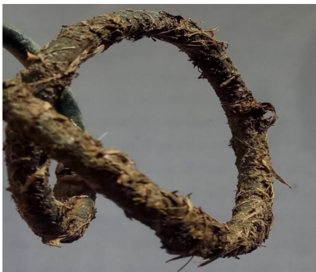
Рисунок 6 – Отложения на наружной поверхности змеевика
