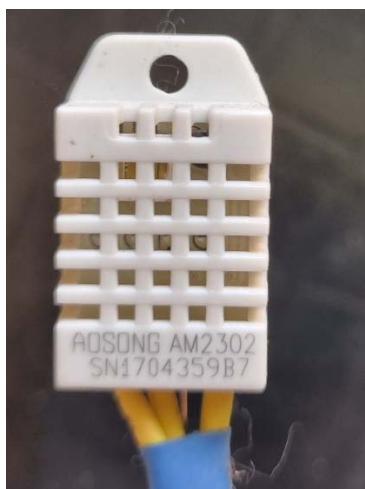
Рисунок 4.6 – Датчик DHT-22. Общий вид
