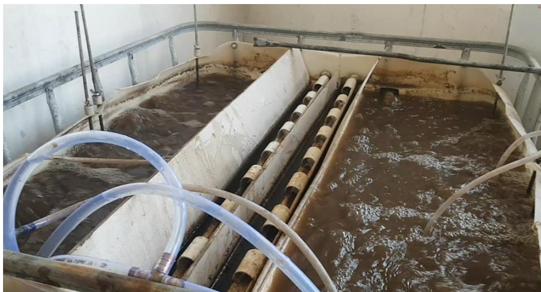
Рисунок 10 - Общий вид эрлифтного биореактора (ЭБ)
