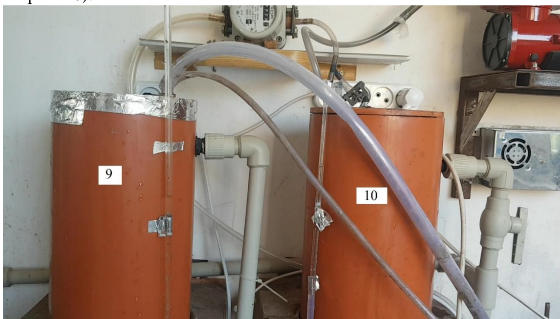
Рисунок 9 - Общий вид блока анаэробного (9) и аноксидного (10) реакторов (А+А).
