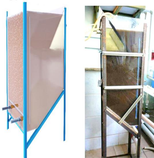
Рисунок 1 – 3D-модель и фото лабораторной установки по исследованию степени осветления в эрлифтном биореакторе
