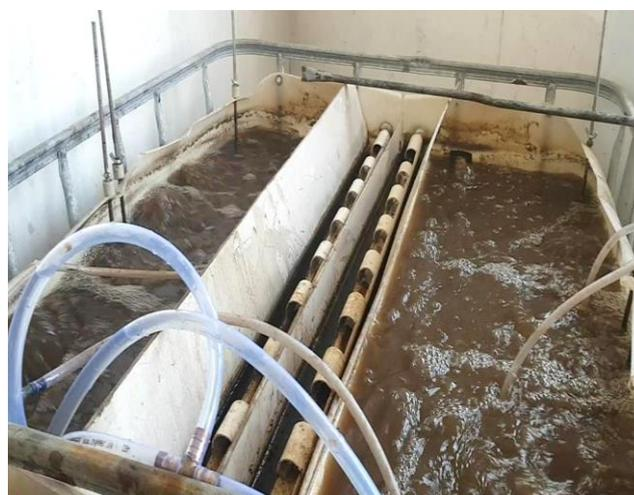
Рисунок 2 – Общий вид опытно-промышленной установки очистки сточных вод в эрлифтном биореакторе
