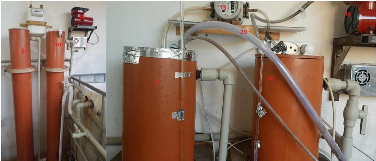
Рисунок 4.20 - Устройство анаэробного и аноксидного реакторов
