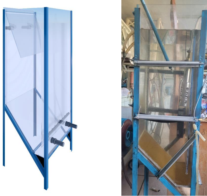
Рисунок 2.2 – 3D-модель и фото лабораторной установки по исследованию степени использования кислорода в эрлифтном биореакторе.
