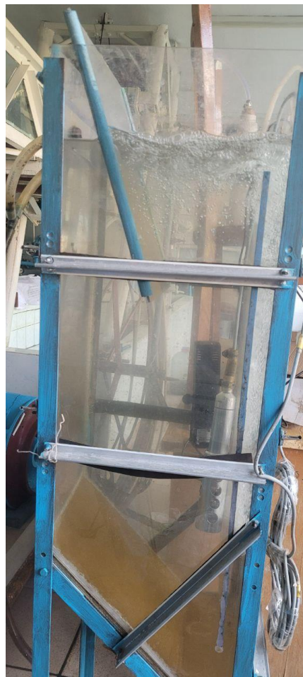
Рисунок 3.10. Проведение экспериментов по определению коэффициента использования кислорода.
