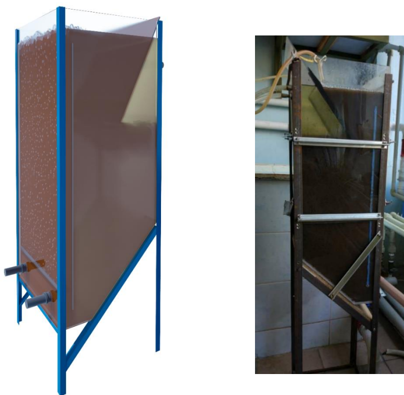
Рисунок 2.6 - 3D-модель и фото лабораторной установки по исследованию степени осветления в эрлифтном биореакторе.
