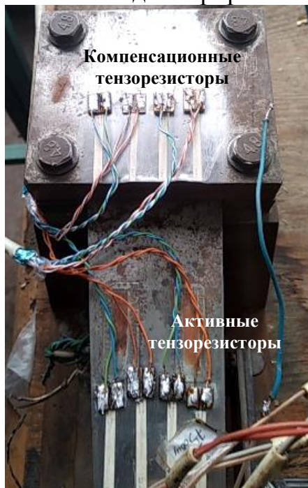
Рисунок 4.16 – Расположение активных и компенсационных тензорезисторов
