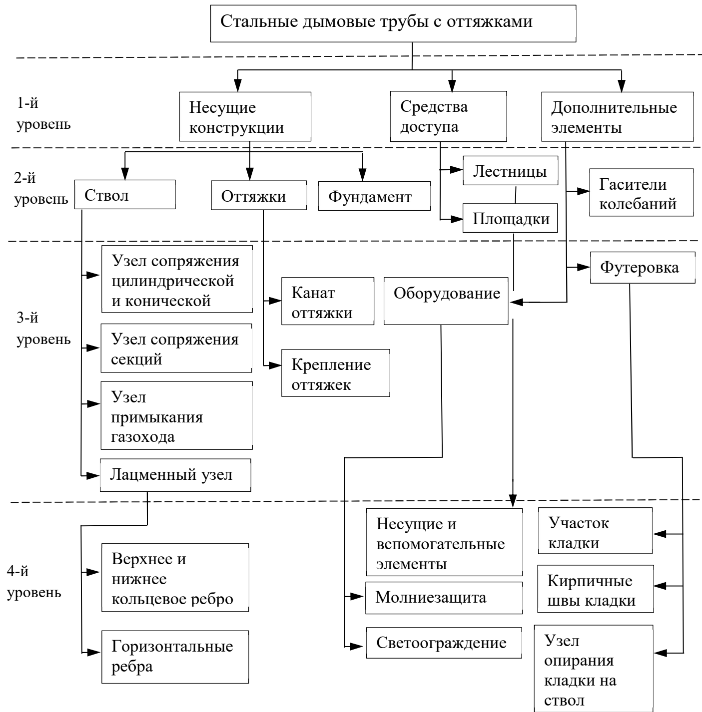
Рисунок 3.1 – Структурная схема и зонирование стальных дымовых труб с оттяжками для выполнения обслуживания.
