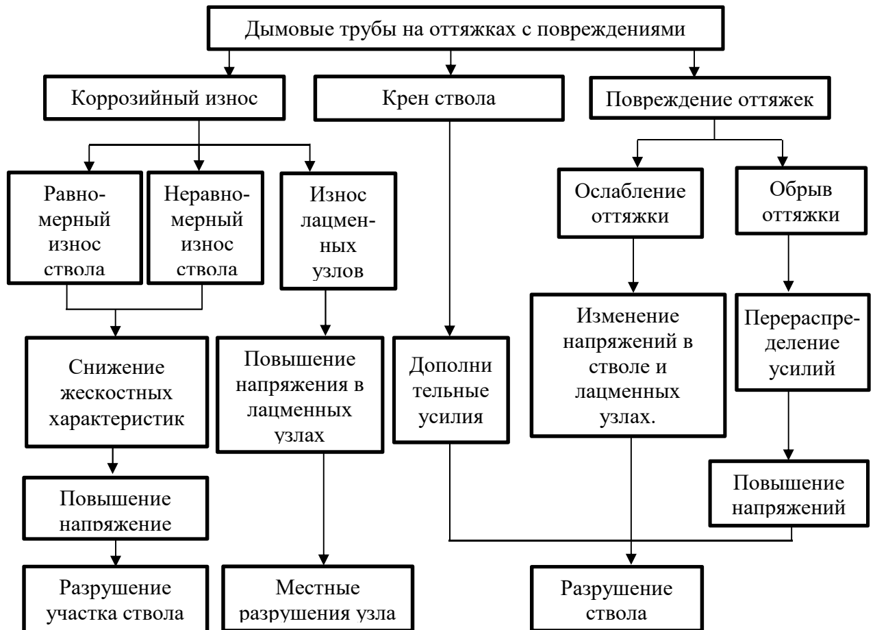
Рисунок 4.22 – Влияния выявленных повреждений на несущую способность дымовых труб с оттяжками
