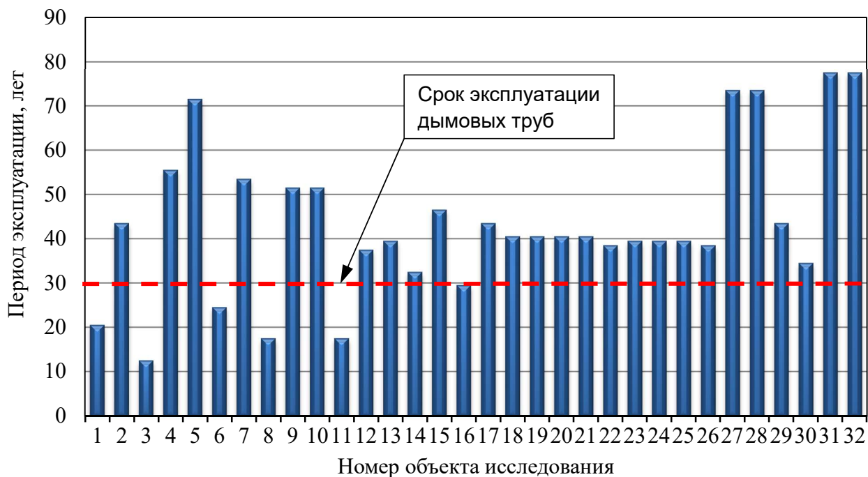
Рисунок 3.2 – Период эксплуатации исследуемых дымовых труб
