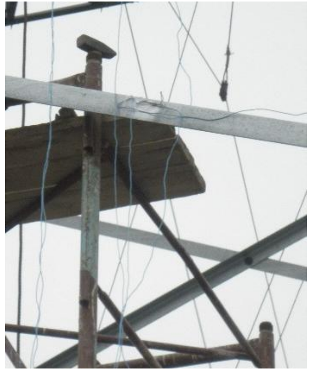
Рисунок 3.4 - Фрагмент цепи датчиков: а) на стволе опоры; б) на решетке опоры.
