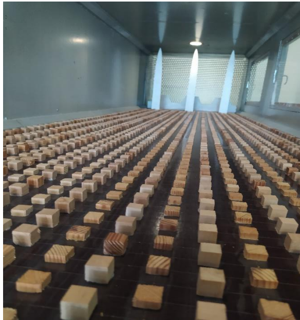
Рисунок 2.5 – Элементы шероховатости модели приземного пограничного слоя атмосферы в трубе МАТ-1
