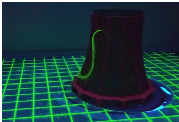
Рисунок 2.12 – Испытуемая модель, установленная в аэродинамической трубе МАТ-1 с прикрепленными люминесцентными шелковинками
