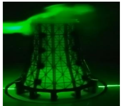
Рисунок 4.7 – Визуализация обтекания двенадцатигранной гиперболической градирни, плоскость XOZ
