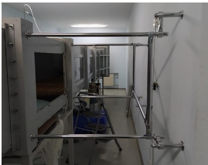
Рисунок 2.10 – Рама для установки и выверки плоскости сечения лазерного ножа.
