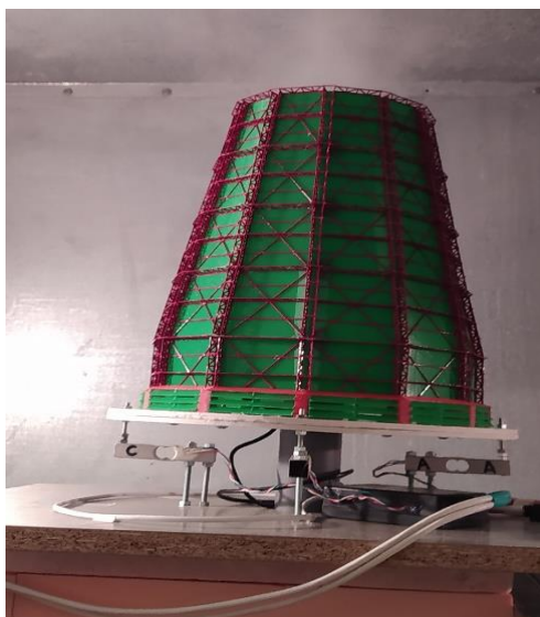
Рисунок 4.18 – Стенд для определения распределения технологической наледи, размещённый в морозильной камере ДОННАСА
