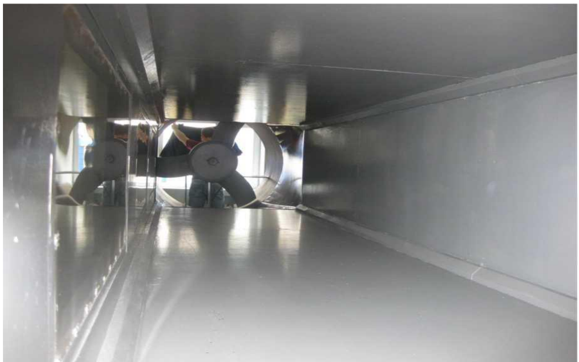
Рисунок 2.2 – Рабочая часть МАТ-1 ДОННАСА.
