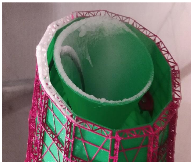
Рисунок 4.19 – Распределение технологической наледи при воздействии ветрового потока на грань БМГ при температуре -6\text{ С}^{\circ}
