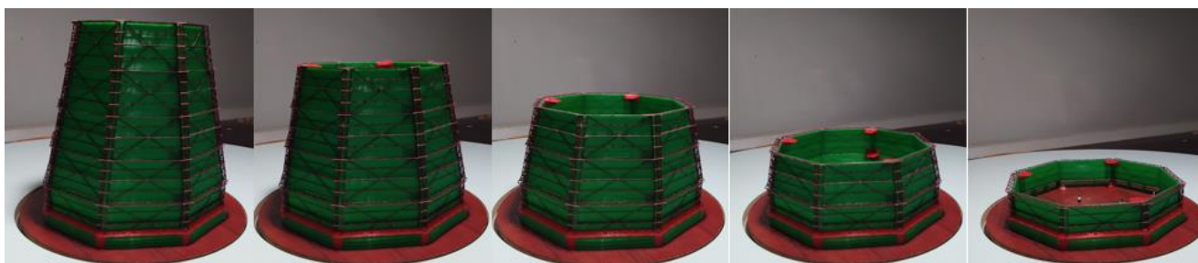
Рисунок 2.8 – Модельный ряд восьмигранной градирни с учетом монтажных стадий
