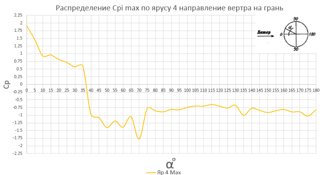
Рисунок 4.9 – Экспериментальные данные распределения C_p расположенных на стыке четвертого и пятого ярусов двенадцатигранной БМГ гиперболической формы.
