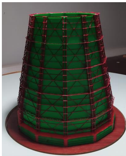
Рисунок 3.11 – Макет башенной металлической двенадцатигранной градирни пирамидальной формы площадью орошения 1600\text{ м}^2 , расположенный в рабочей части МАТ-1(летний период эксплуатации)
