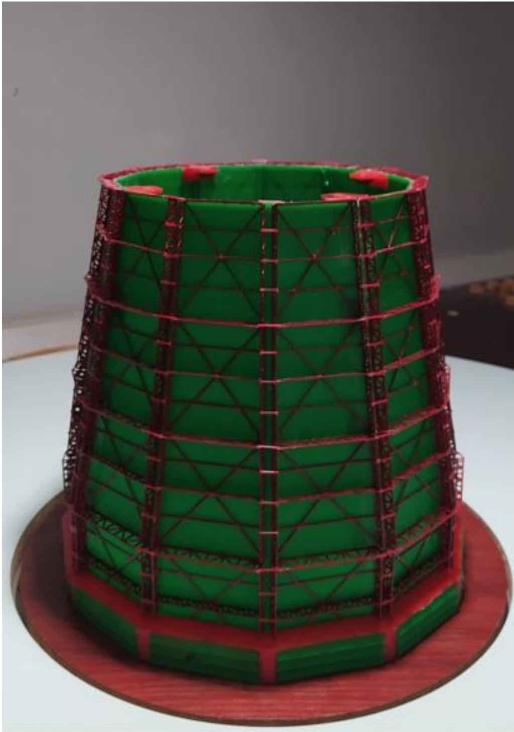
Рис. 26. Макет башенной металлической двенадцатигранной градирни пирамидальной формы площадью орошения 1600м 2 расположенный в рабочей части МАТ-1 (монтажная стадия замыкание карт четвертого яруса)
