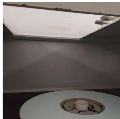
Рисунок 2.11 – Смотровое окно в верхней части аэродинамической трубы МАТ-1
