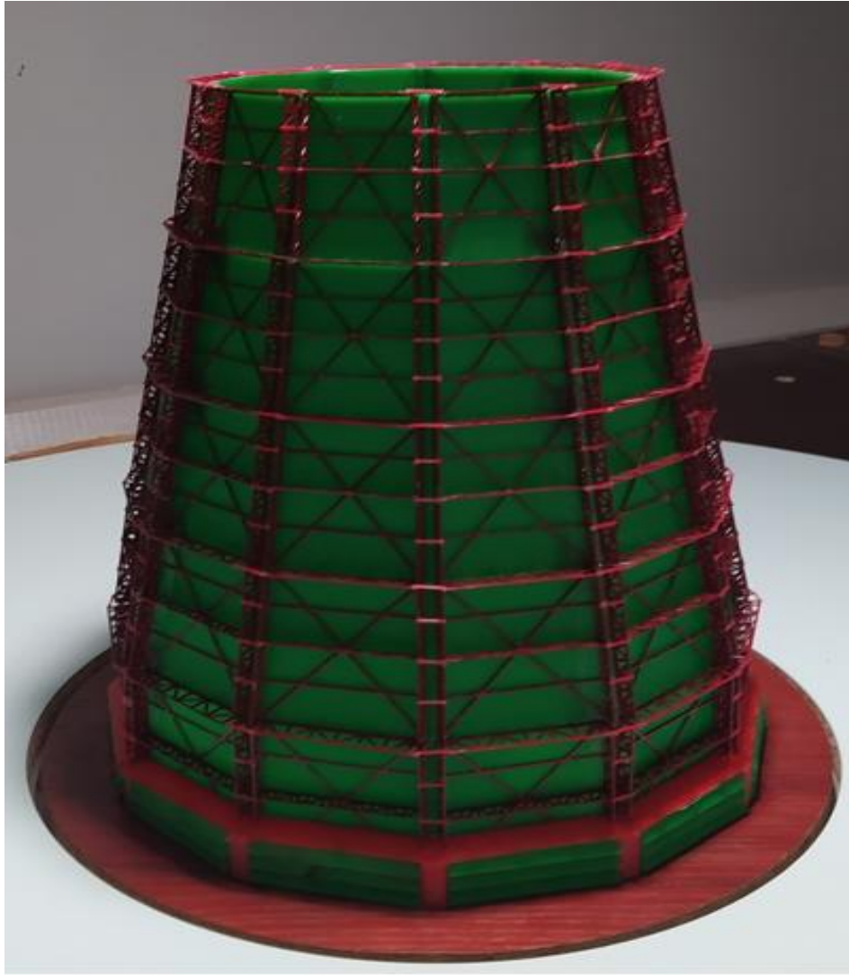
Рисунок В.16 Макет башенной металлической двенадцатигранной градирни пирамидальной формы площадью орошения 1600\text{м}^2 расположенный в рабочей части МАТ-1(летний период эксплуатации)
