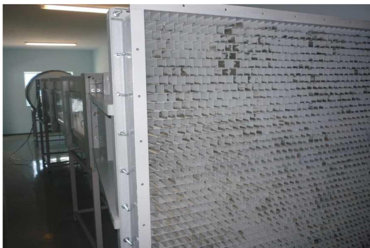
Рисунок 2.3 – Сопло с Хонейкомбом МАТ-1 ДОННАСА.
