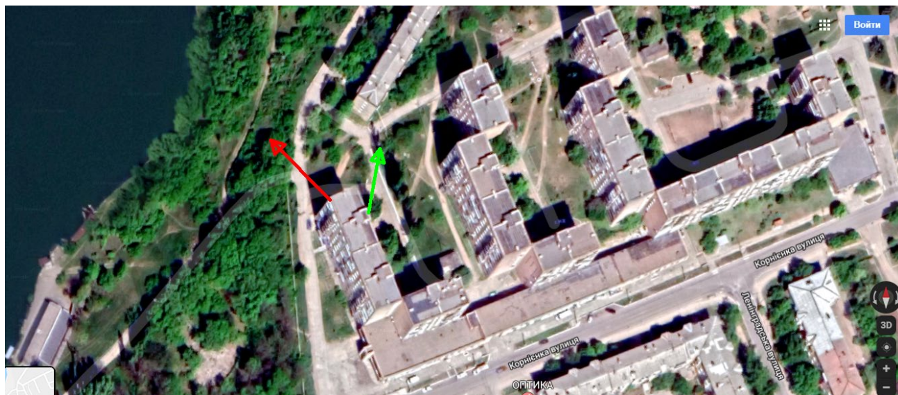
Рис. 4.11 Направление кренов жилого дома №6 по ул. Корниенко в г. Зугрэс: красный – до усиления фундаментов, зеленый – после усиления фундаментов
