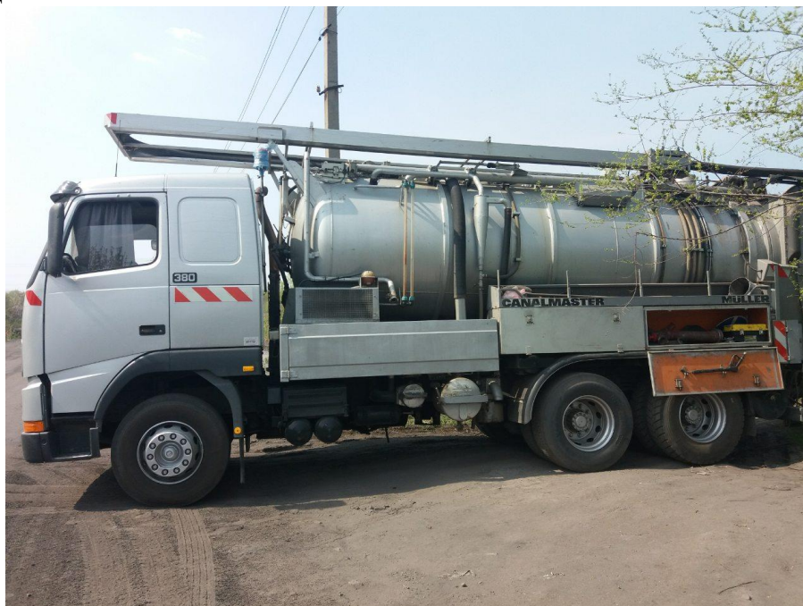
Рисунок 2 - Машина по гидромеханической очистке базе автомобиля Volvo
