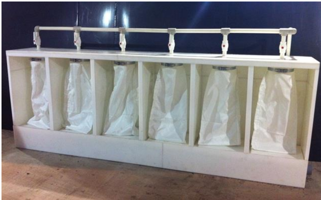
Рисунок 3 - Установка обезвоживания осадков мешкового типа
