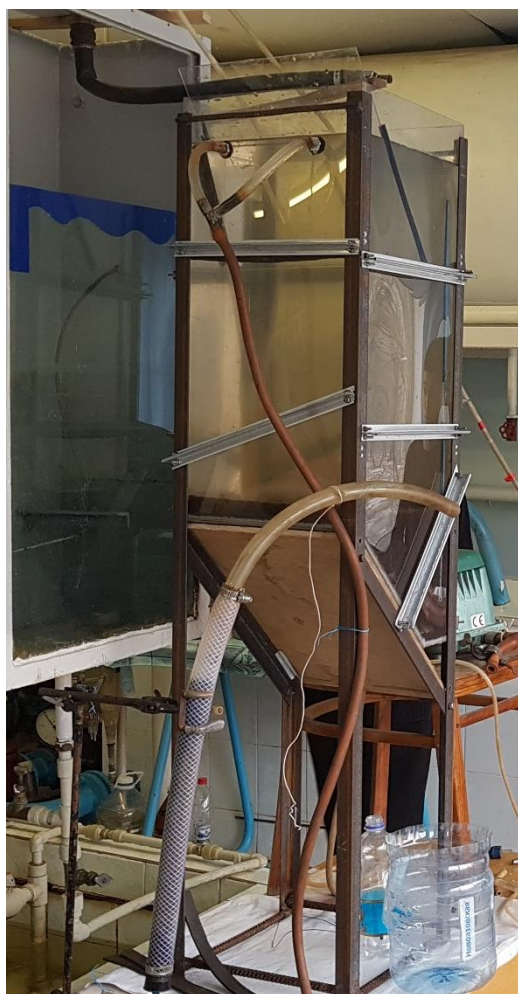
Рис. 1 Фото и схема пилотной установки комплексной очистки сточных вод.
