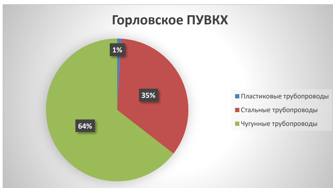
Рис. 2. Статистический анализ аварий на водопроводных сетях по материалам труб (г. Горловка)
