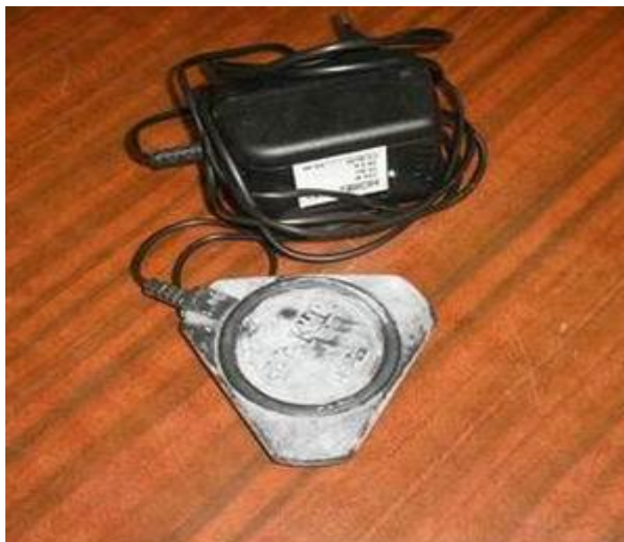
Рисунок 1. Лабораторная противонакипная установка. Вверху-генератор колебаний 50-110 кГц, внизу – излучатель этих колебаний, помещаемый в воду.
