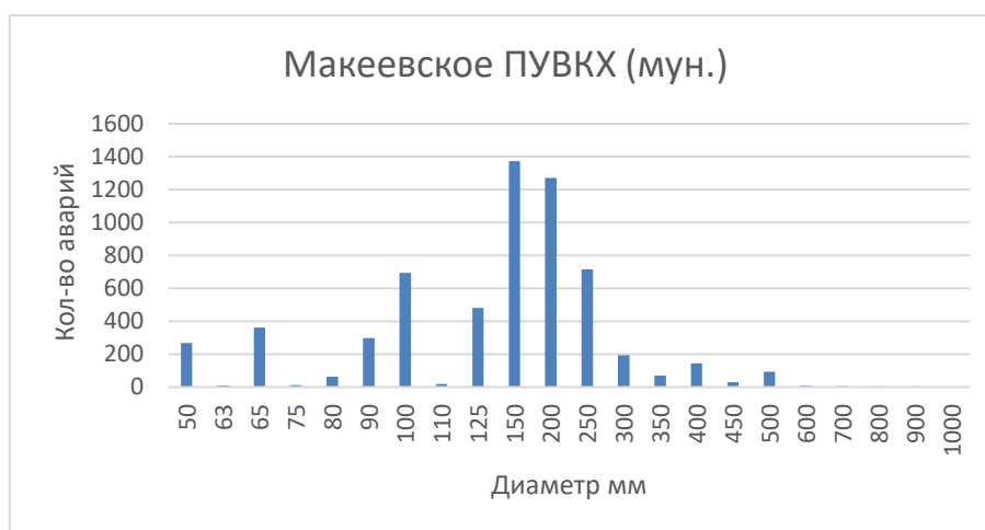
Рис. 5. Количество аварий трубопроводов различных диаметров (г. Макеевка)
