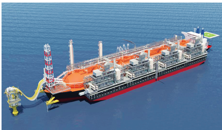
Конверсия танкера по перевозке сжиженного природного газа (СПГ) Moss – Golar-Kerrel. Впервые в мире осуществлена конверсия СПГ-танкера в плавучий завод по сжижению природного газа. Использована запатентованная технология сжижения газа PRICO® корпорации Black & Veatch
