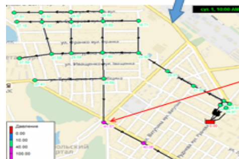
Моделирование работы сети в программе Epanet (США) с поиском зон повышенного давления и определением параметров регуляторов.
