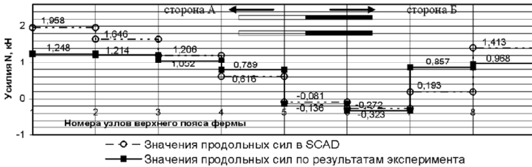
Рис. 5. Зависимости продольных сил N , кН узлов верхнего пояса фермы 1 от снеговой нагрузки на половину пролета ближе к узкой части (Загружение 1).
