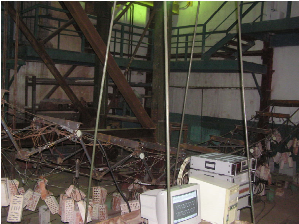
Рис. 2. Экспериментальная установка модели блока висячих ферм.
