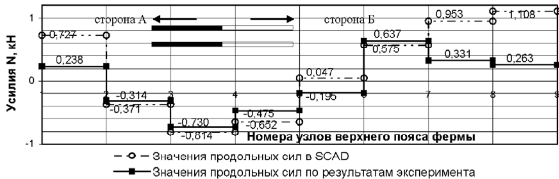
Рис. 7. Зависимости продольных сил N , кН узлов верхнего пояса фермы 1 от снеговой нагрузки на половину пролета ближе к широкой части (Загружение 2).
