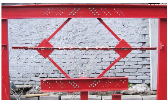
Рис. 4. Изменение эффективной длины стержня на различных этапах испытаний:
