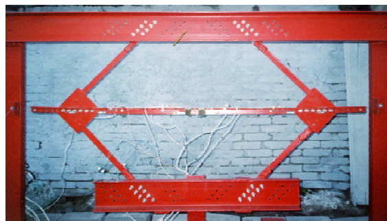
Рис. 4. Изменение эффективной длины стержня на различных этапах испытаний:
