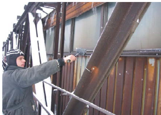
Рис. 6. Возбуждение поперечных колебаний стержня в плоскости фермы.
