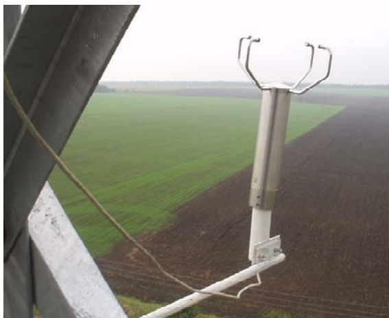
Рис. 3. Внешний вид ультразвукового анемо-румбометра на башне ВЭУ.
