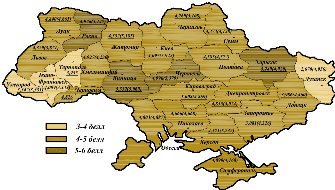
Рис. 4. Территориальная оценка показателя надёжности P_L металлоконструкций, воспринимающих постоянную и ветровую (доля влияния C_2 = 0.7 ) нагрузки.
