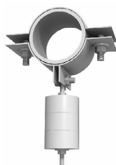
Рис. 8. Схема крепления сосредоточенной массы на стержне трубчатого сечения.
