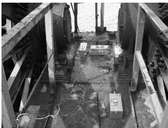
Рис. 4. Размещение сейсмографов и тензометрических датчиков на подшивных конструкциях копра.
