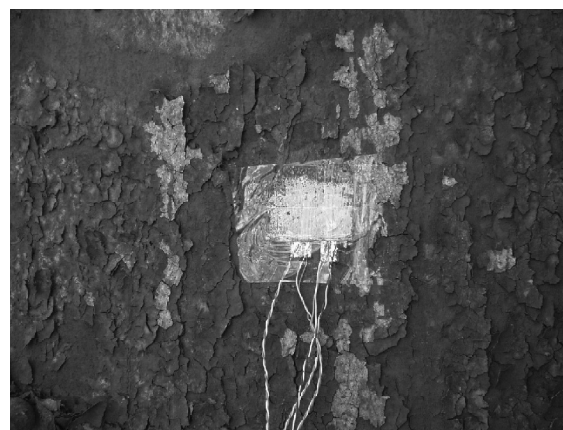
Рис. 4. Размещение сейсмографов и тензометрических датчиков на подшивных конструкциях копра.
