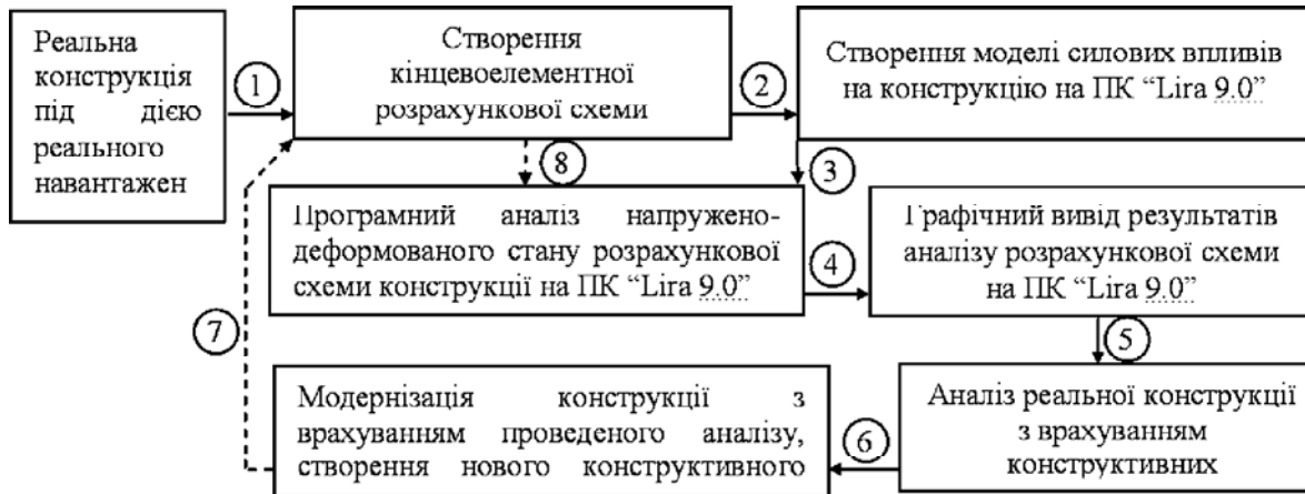
Рис. 2. Алгоритм моделювання напружено-деформованого стану конструкції на програмі "Lira 9.0", де процедури 1, 2, 3, 5, 6 виконуються користувачем; процедура 4 – розрахунковою програмою; процедури 7, 8 – виконуються користувачем у випадку раціоналізації конструкції.
