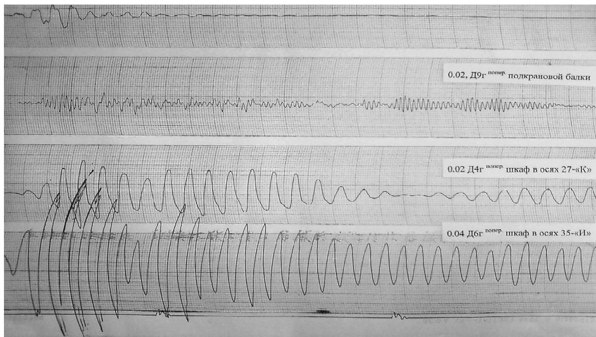
**Рис. 5.** Виброграммы колебаний узла опирания подкрановой балки на колонну (верхняя) шкафа КИП и электроцита термопечи (нижние) при падении плиты массой 400 кг с высоты 3 м - в 50 м от датчиков (станции № 4, 5, 6).
