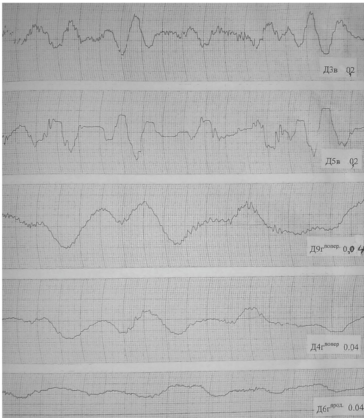
**Рис. 4.** Виброграммы колебаний покрытия в пролете "К-II" (к.о. "0,02", станция №2) при продольном движении крана с ящиком брикетов.
