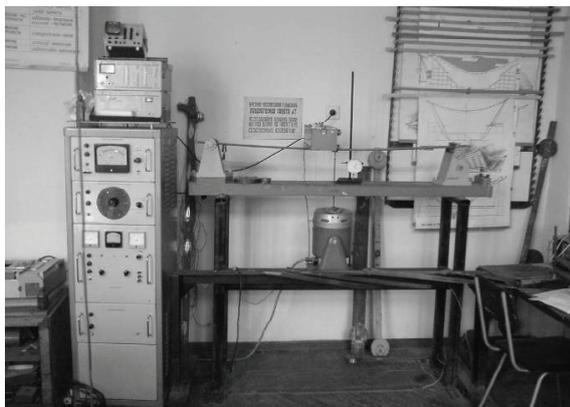
**Рис. 2.** Установка для тарировки сейсмографов ВЭГИК на вибростенде ВЭДС-10а.
