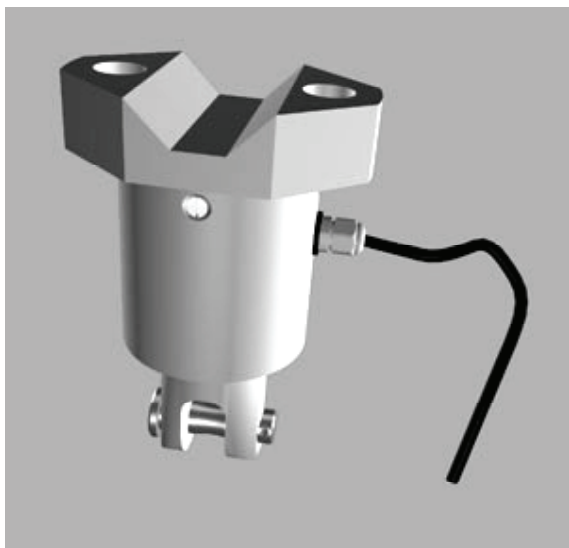
Рис. 2. Датчик гололедно-ветровой нагрузки (ДГВН) системы предупреждения о гололедообразовании на воздушных линиях электропередачи: а – общий вид; б – схема установки.
