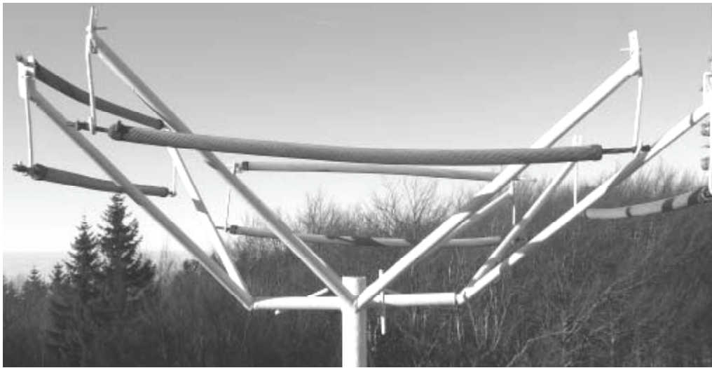
Рис. 5. Устройство измерения гололедной нагрузки на вращающихся образцах проводов (Венгрия).
