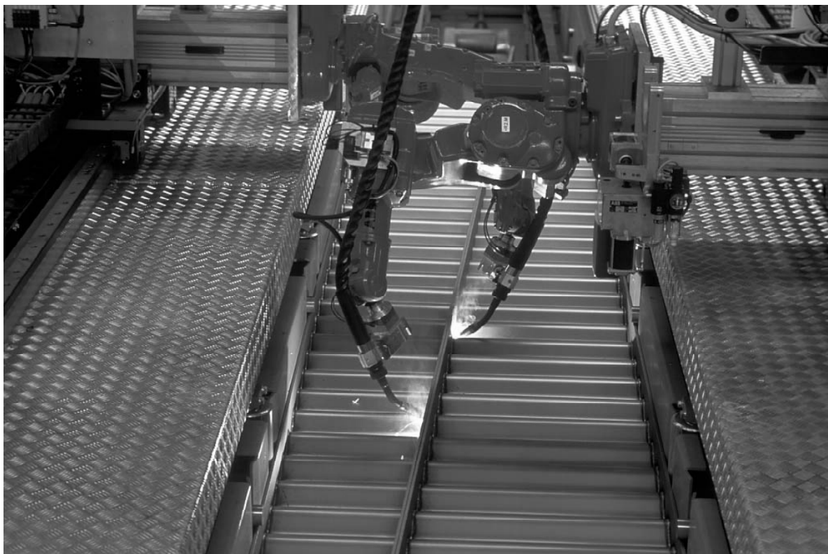
Рис.3. Линия для сваривания гофрированных стенок с поясами.
