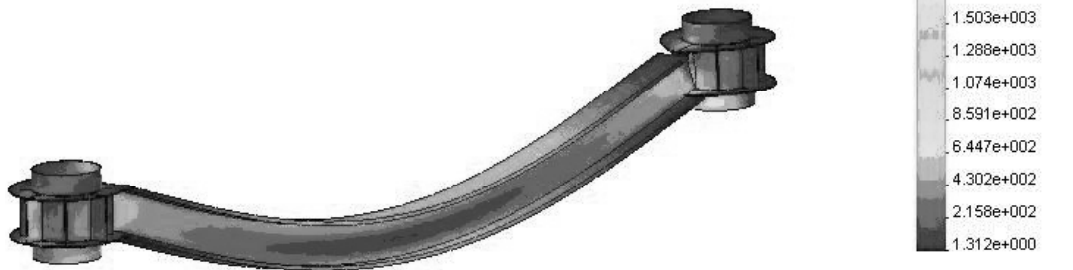
Рис. 13. Напряжения по Мизесу. Шаг итерации 25, соответствующий полному загрузению балки и упруго-пластической работе материала.
