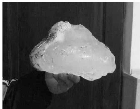
Рис. 5. Фрагменты гололедно-изморозевых отложений с провода и чашки изолятора.
