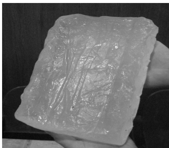
Рис. 4. Фрагменты гололедно-изморозевых отложений с поясного уголка опор.
