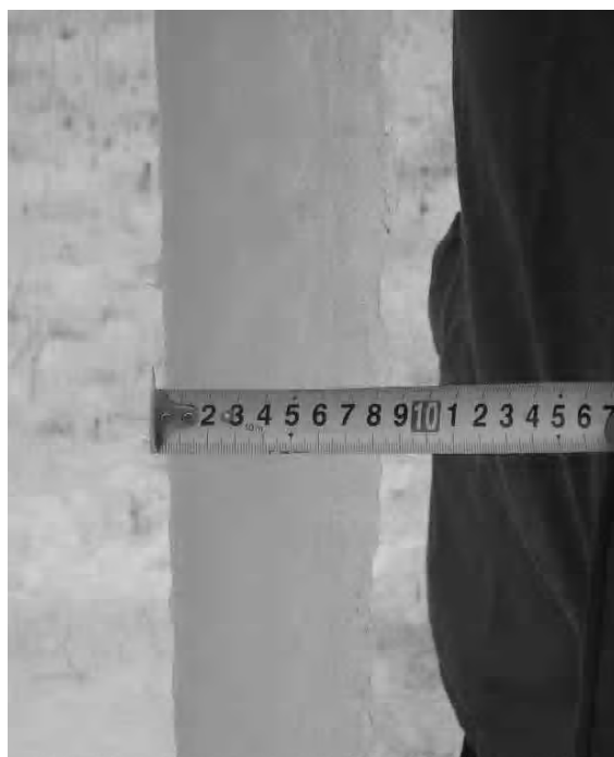
Рис. 3. Замер гололедно-изморозевых отложений на проводах в полевых условиях.
