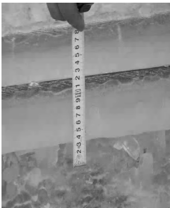
Рис. 3. Замер гололедно-изморозевых отложений на проводах в полевых условиях.
