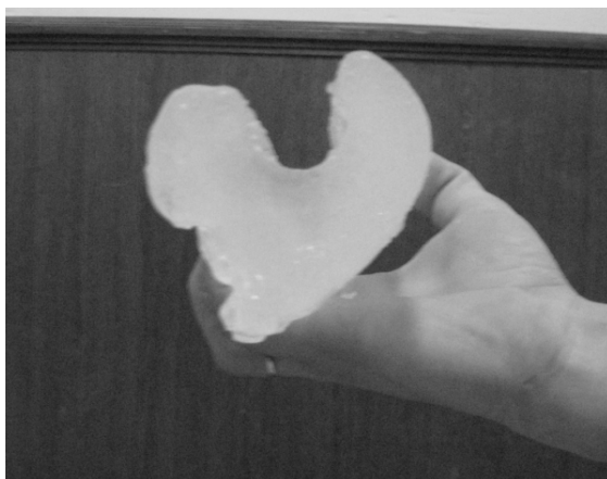
Рис. 5. Фрагменты гололедно-изморозевых отложений с провода и чашки изолятора.
