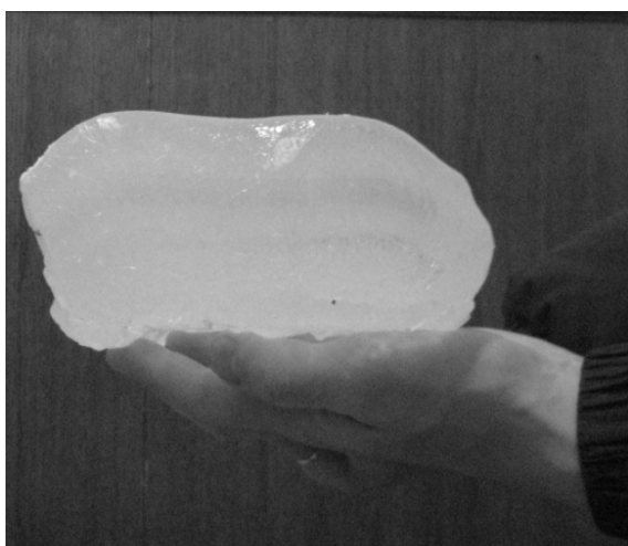
Рис. 4. Фрагменты гололедно-изморозевых отложений с поясного уголка опор.
