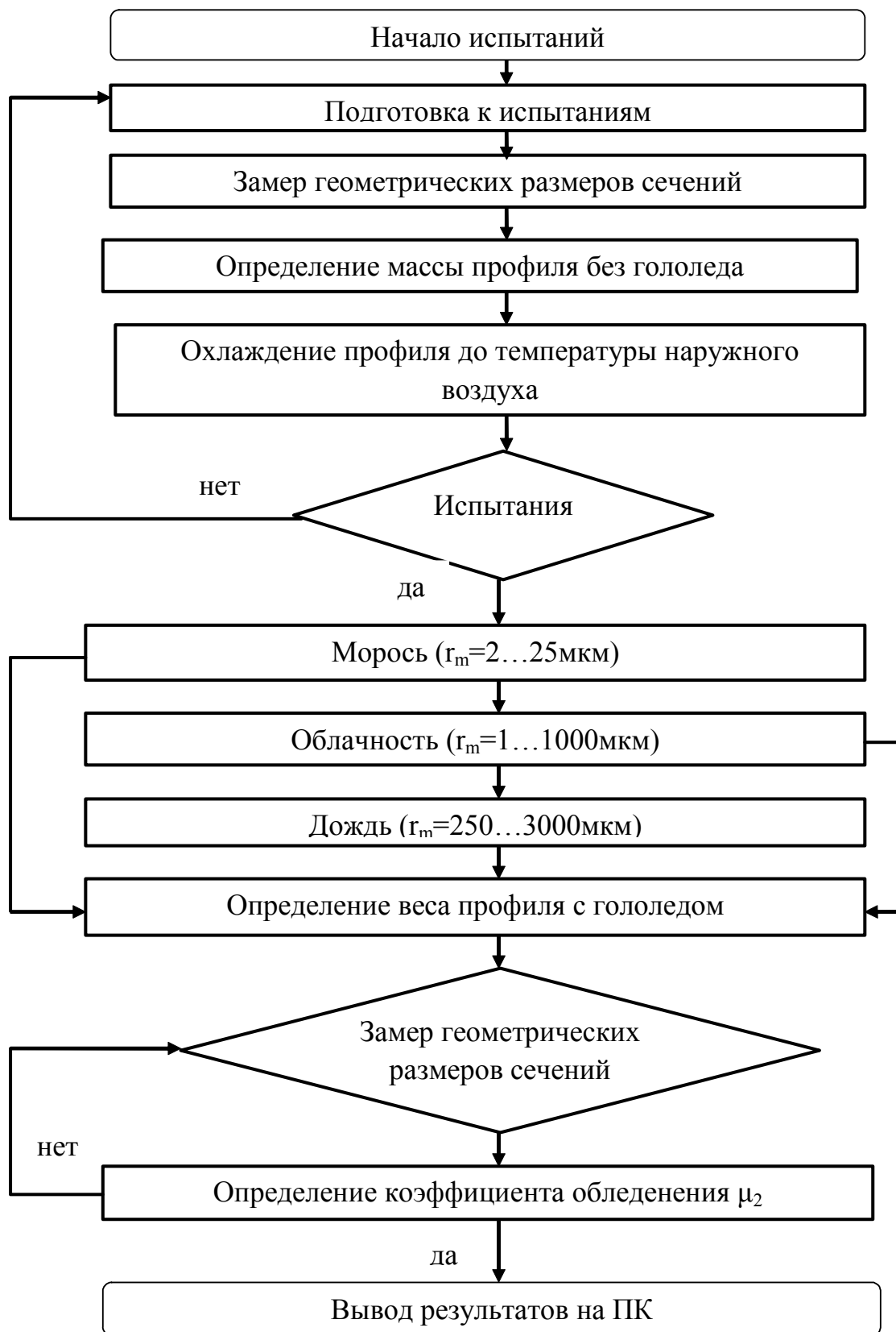
Рис. 5. Блок-схема имитации гололеда в камере.
