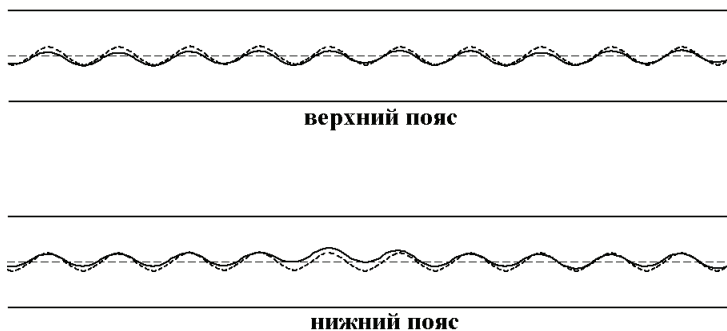
Рисунок 1. Модель экспериментальной конструкции: а – геометрия; б – натурное формобразование гофрированной стенки (фрагмент).
