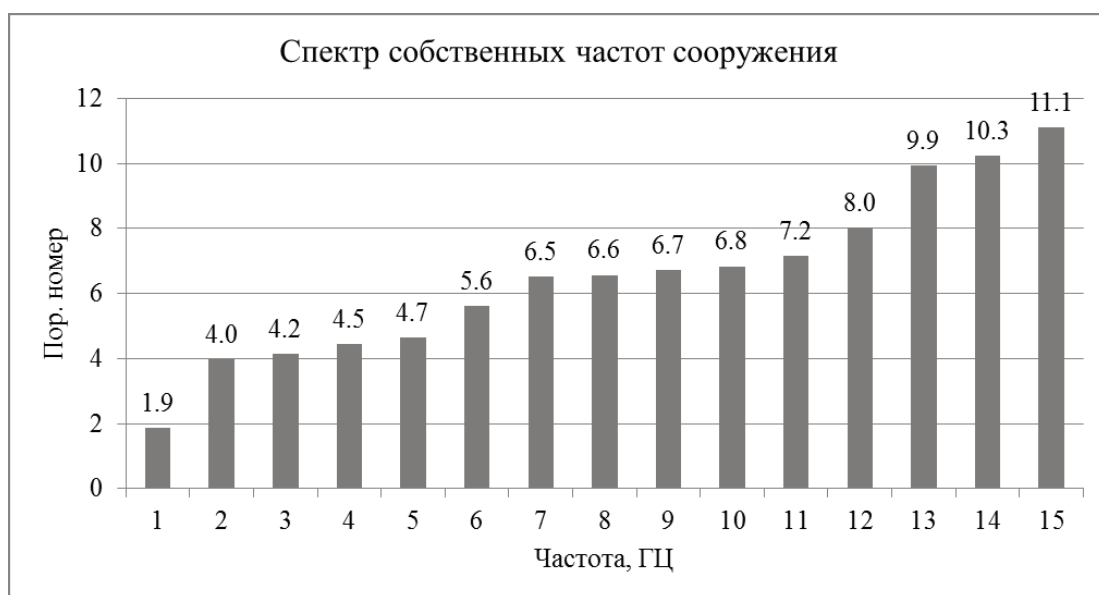
Рисунок 10. Спектр собственных частот сооружения как стержневой системы.
