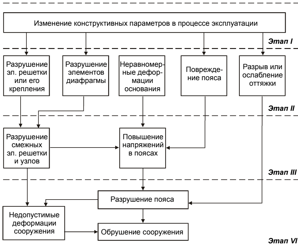
Рисунок 1. Последовательность отказов несущих конструкций решетчатых сооружений.
