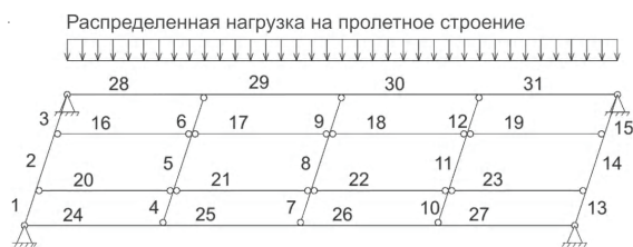
Рисунок 6. Нагрузки, действующие на пролетное строение.
