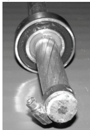
Рисунок 4. Новые типы проводов: а – провода марки Аеро-Z (177-1Z, 242-2Z, 301-2Z, 366-2Z, 504-2Z); б – провод марки AFLs10-240.
