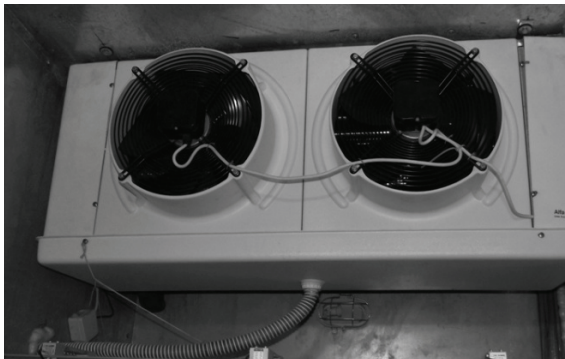
Рисунок 2. Экспериментальная установка: а – общий вид климатической камеры ДонНАСА; б – вентилятор, нагнетательный и обратный воздушные каналы с наружной теплоизоляцией; в – насосная станция и резервная емкость для воды; г – блок форсунок; д – холодильная установка (кондиционер); е – тензодинамометры, закрепленные на кронштейне и предназначенные для измерения веса гололедных отложений на образце провода (два крайних) и эталонном стержне (средний).
