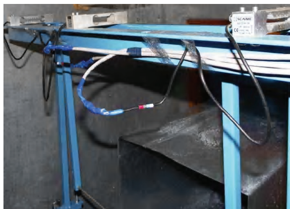
Рисунок 1. Экспериментальная установка: а – общий вид установки; б – измерение веса гололедных отложений с помощью тензодинамометров.
