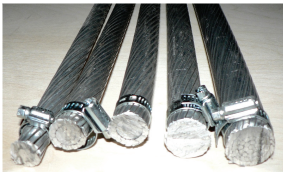
Рисунок 2. Образцы новых типов проводов: а – провода марки Аеро-Z (177-1Z, 242-2Z, 301-2Z, 366-2Z, 504-2Z); б – провод марки AFLs10-240.
