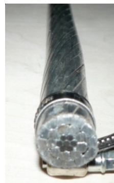
Рисунок 2. Образцы новых типов проводов: а – провода марки Аеро-Z (177-1Z, 242-2Z, 301-2Z, 366-2Z, 504-2Z); б – провод марки AFLs10-240.
