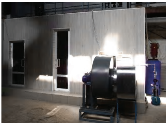
Рисунок 1. Экспериментальная установка: а – общий вид установки; б – измерение веса гололедных отложений с помощью тензодинамометров.
