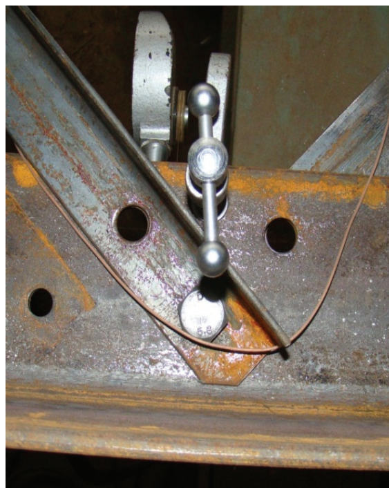
Рисунок 5. Общий вид узла с одноболтовым креплением раскосов.
