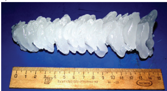
Рисунок 9. Испытания устройства измерения веса ГИО (стержень ориентирован под углом 45° к гололедонесущему потоку): а – устройство измерения веса ГИО в климатической камере; б – гололедное отложение на стержне датчика; в, г – структура гололедного отложения.
