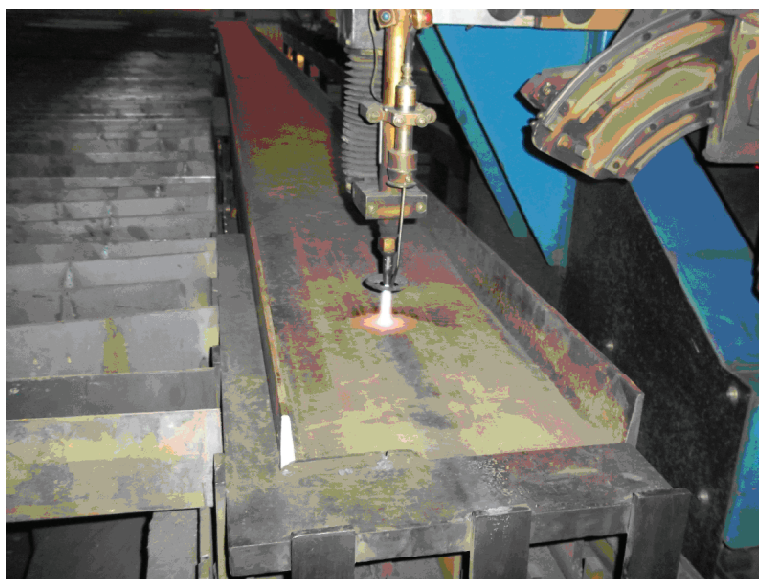
Рисунок 6. Схема № 1 – Предварительный подогрев стенки двутавра одной горелкой.
