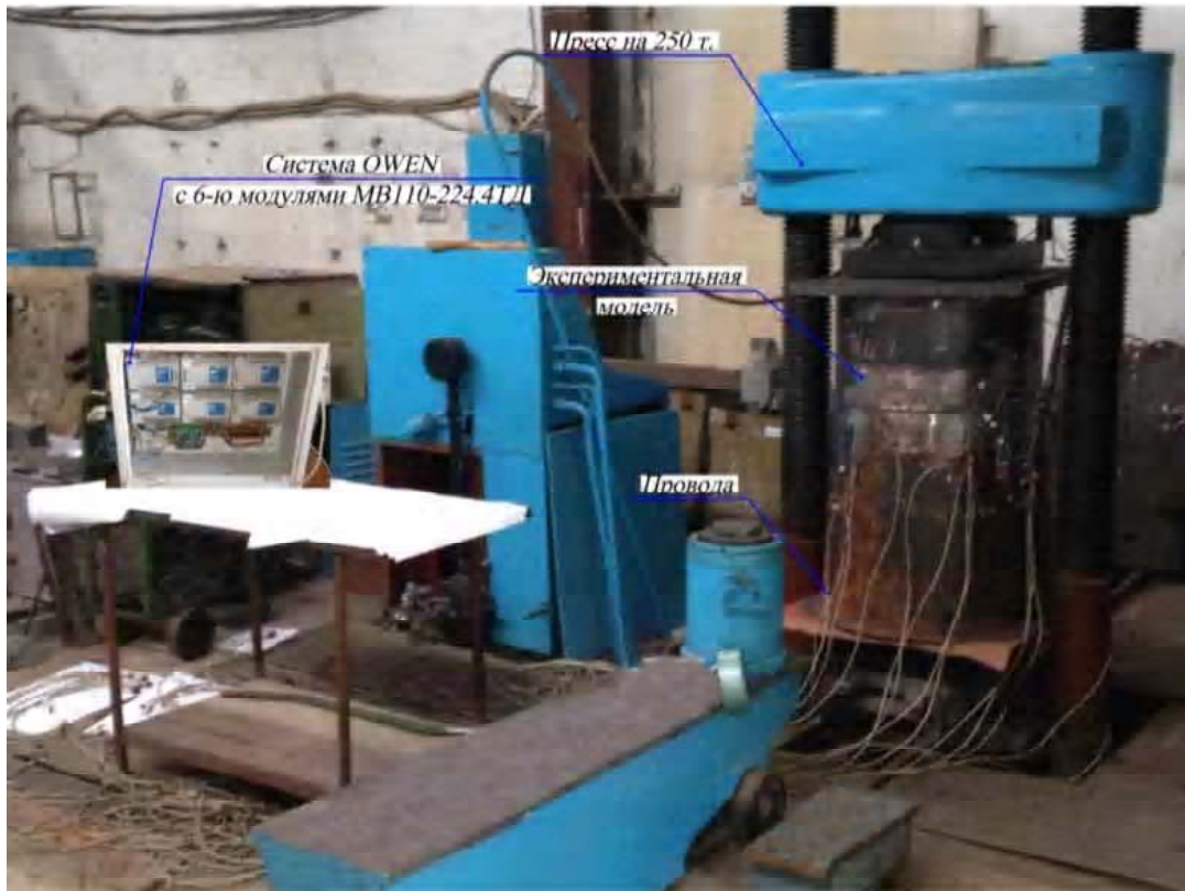
Рисунок 5. Общий вид испытательной установки.
