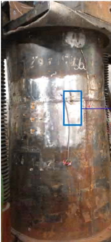
Рисунок 7. Распределение эквивалентных напряжений по высоте экспериментальной модели, МПа: а) общий вид участка; б) \sigma_{eq} в зоне с эксцентриситетом.
