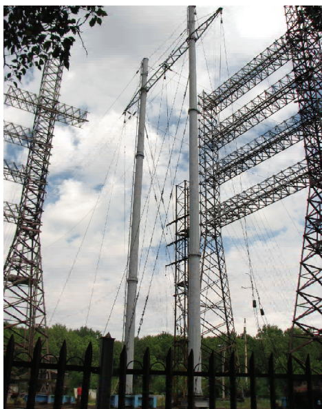
Рисунок 5. Испытание опоры ПМГ330-28 по 7-й схеме загрузки.
