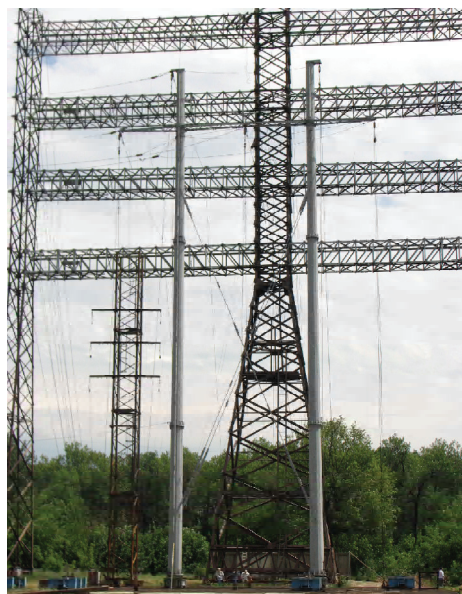
Рисунок 6. Испытание опоры ПМГ330-28 по 1-й схеме загрузки.
