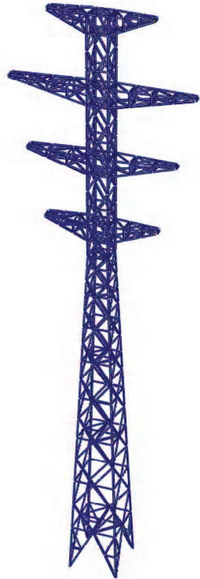
Рисунок 6. Переходная опора № 18: а) геометрическая схема; б) пространственная расчетная модель.
