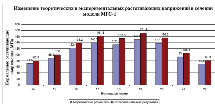
Рисунок 14. Сравнение теоретических и экспериментальных значений нормальных напряжений \sigma_y , в опорной зоне растяжения модели МГС-1.
