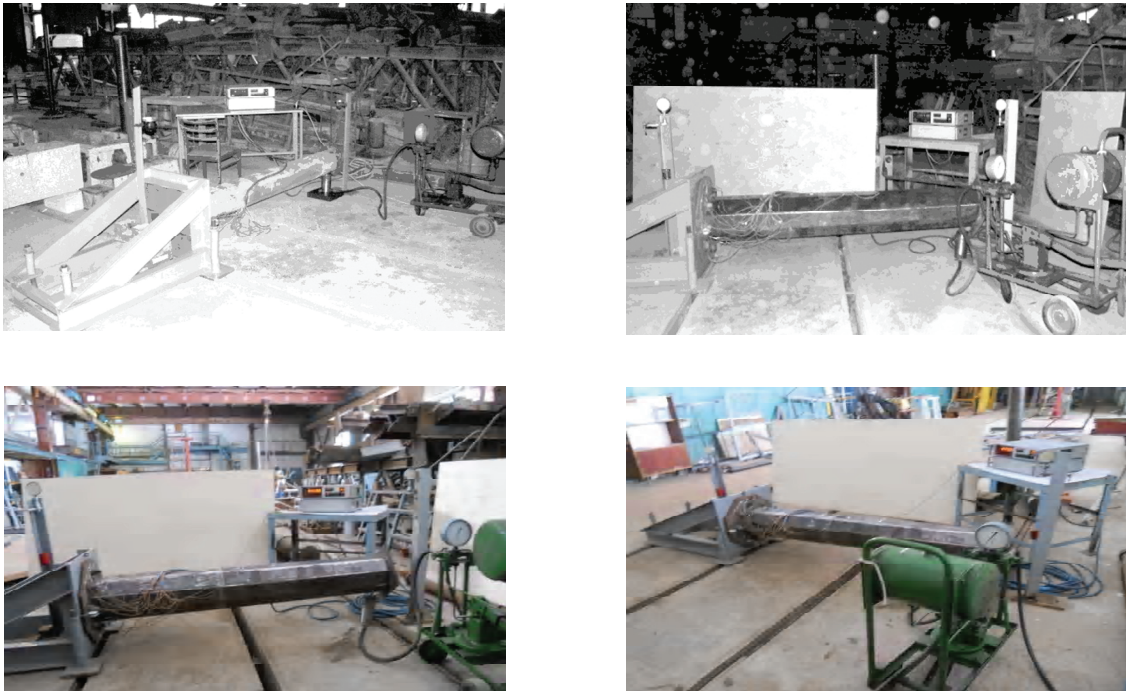
Рисунок 12. Экспериментальные модели МГС высотой h=2 м и количеством граней n=8 , на экспериментальном стенде.
