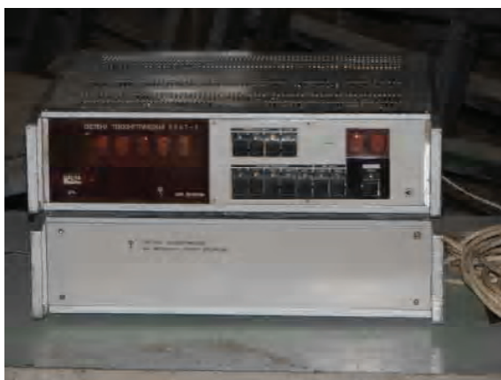
Рисунок 9. Измерительная тензометрическая система СИИТ-3.
