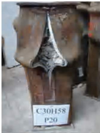
Рисунок 2. Исследования квадратного трубобетона при центральном сжатии.
