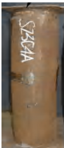
Рисунок 3. Исследования круглого трубобетона при центральном сжатии.
