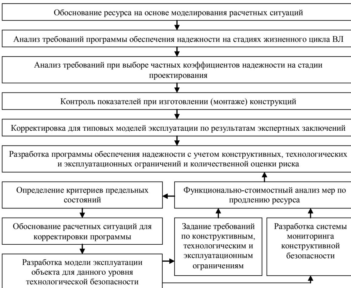
Рисунок 15. Схема основных этапов экспертизы требований технологической безопасности.
