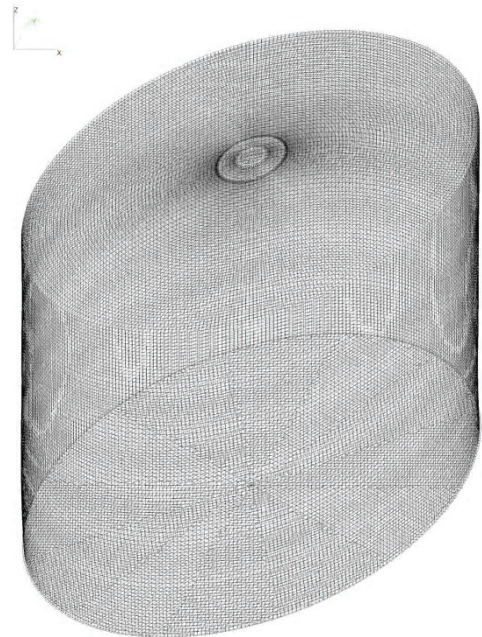
Рисунок 3. Расчетная схема резервуара объемом 1 000 м 3 с геометрическими несовершенствами.
