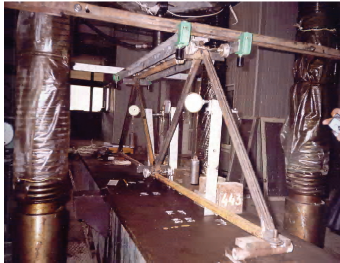
Рисунок 7. Общий вид стенда испытаний плоской фермы со стандартных элементов структуры «ИНЕКО».
