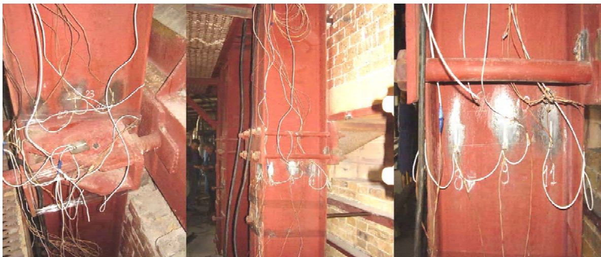
Рисунок 16. Расположение тензодатчиков на исследуемой колонне.
