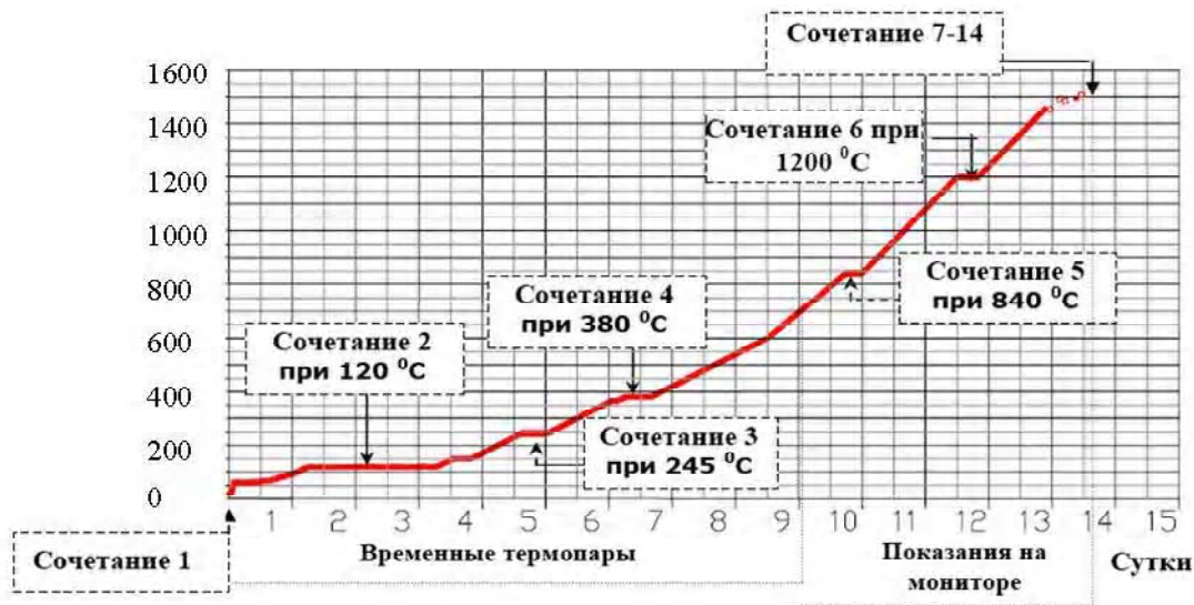
Рисунок 9. График увязки технологического температурного режима выдержки стекловаренной печи и РСН в расчетной модели.
