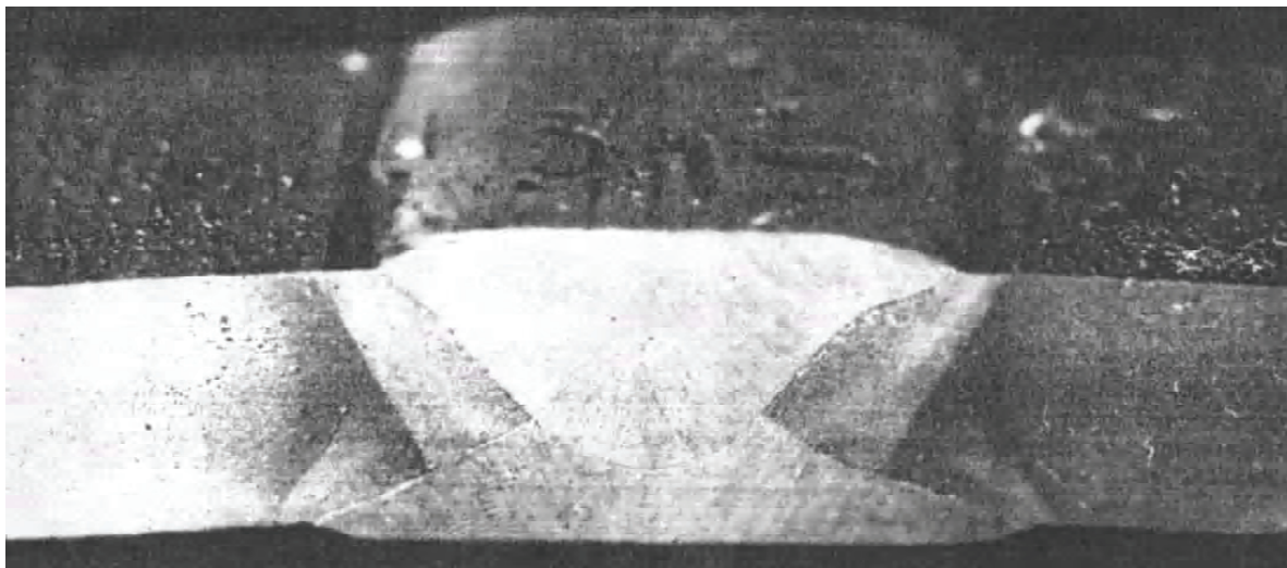
Рисунок 4. Макротемплет исследуемых образцов.
